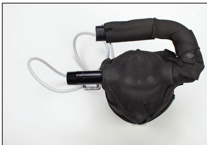
Rys. 8-53 Przepływomierz ze strzałką wskazującą kierunek przepływu; ten sam kierunek, co wylot pompy obiegowej
