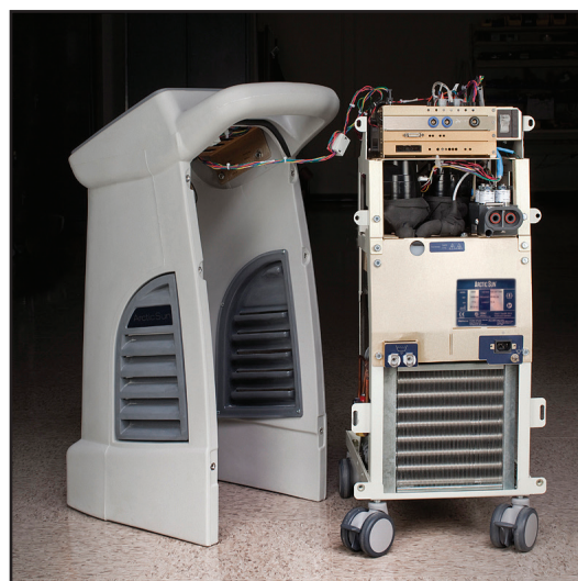
Fig. 8-13 Skall skilt fra innvendige komponenter
