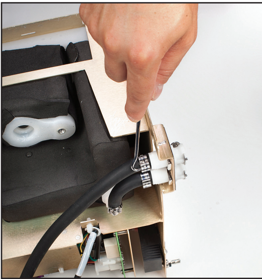
Fig. 8-43 Åpne klemmen som forbinder kjølerpumpeslangen til dreneringsventilen
